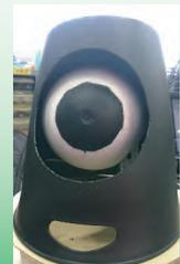
目玉を搭載した自動運転車のイメージ 試作中の目玉ユニット
